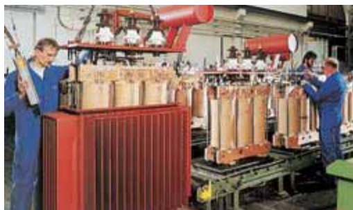
Abb. 3.17: Sperrholz im Transformatorenbau
