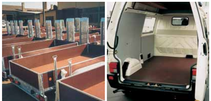
Abb. 3.13: Fahrzeugbodenkonstruktionen aus Sperrholz
