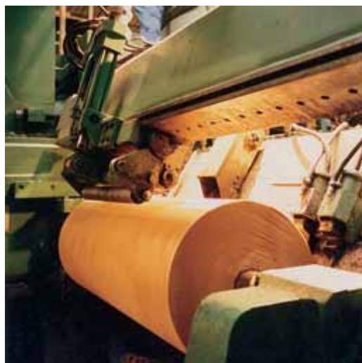
Abb. 2.9: Buchenstamm in der Schälmaschine
