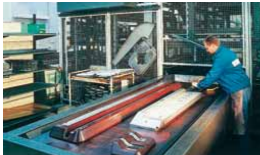
Abb. 3.16: Formwerkzeug aus Sperrholz
