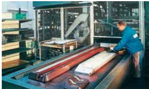
Abb. 3.16: Formwerkzeug aus Sperrholz
