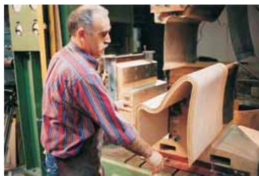
Abb. 3.8: Fertigung von Formsperrholz für den Möbelbau
