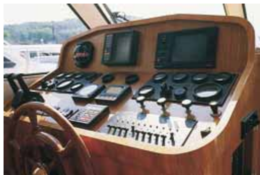
Abb. 3.14: Edle Schiffskonstruktion aus Sperrholz
