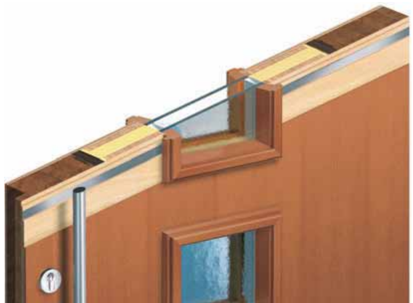
Abb. 3.6: Türkonstruktion mit Sperrholz
