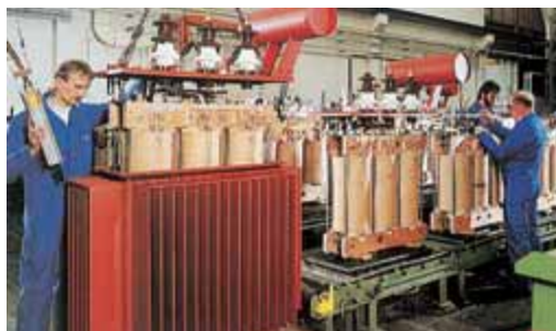
Abb. 3.17: Sperrholz im Transformatorenbau
