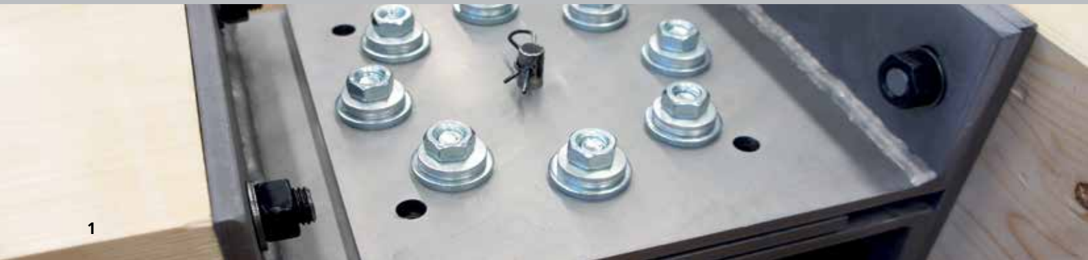
1 Neu entwickelter Momentenverbinder mit angeschlossenen Holzbauteilen.
